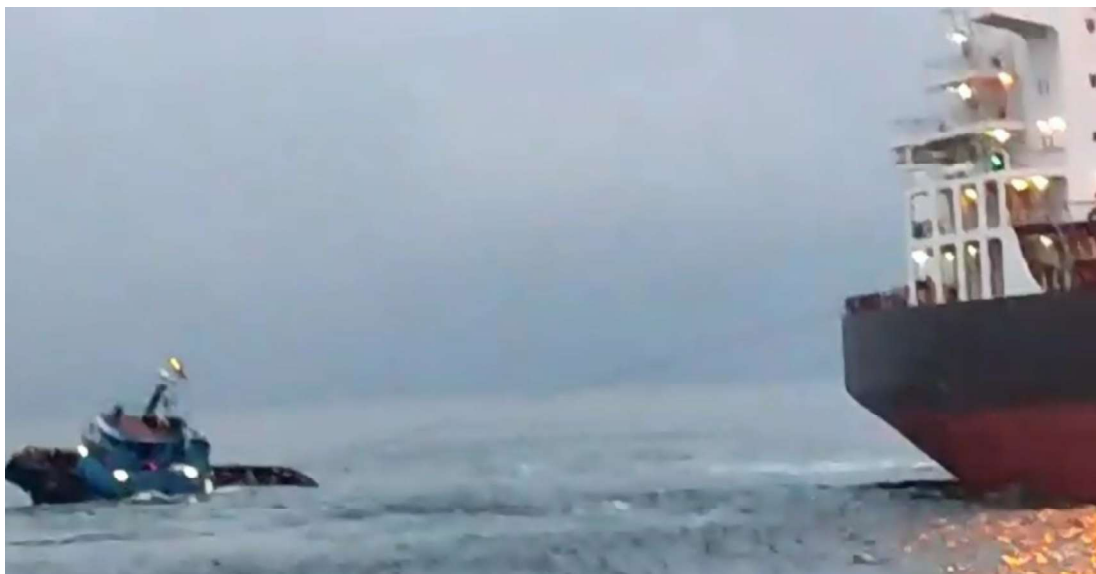
Figura No8.- Imagen donde se logra ver al PIEDAD I incrementar su escora e ingreso de agua a la cubierta. En el video también se puede apreciar personal en la popa de remolcador
