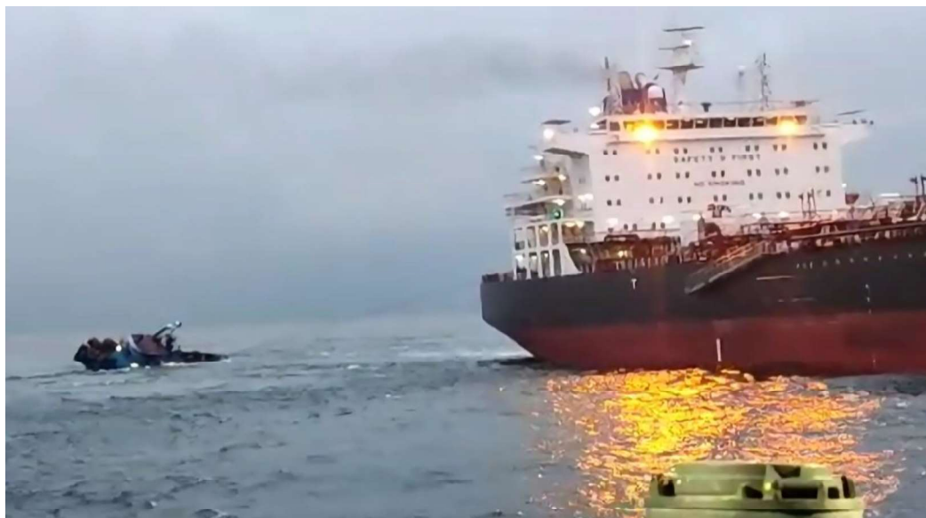
Figura No10.- Imagen donde se logra ver al remolcador PIEDAD I con un ángulo de escora aproximado entre 40° y 60°
