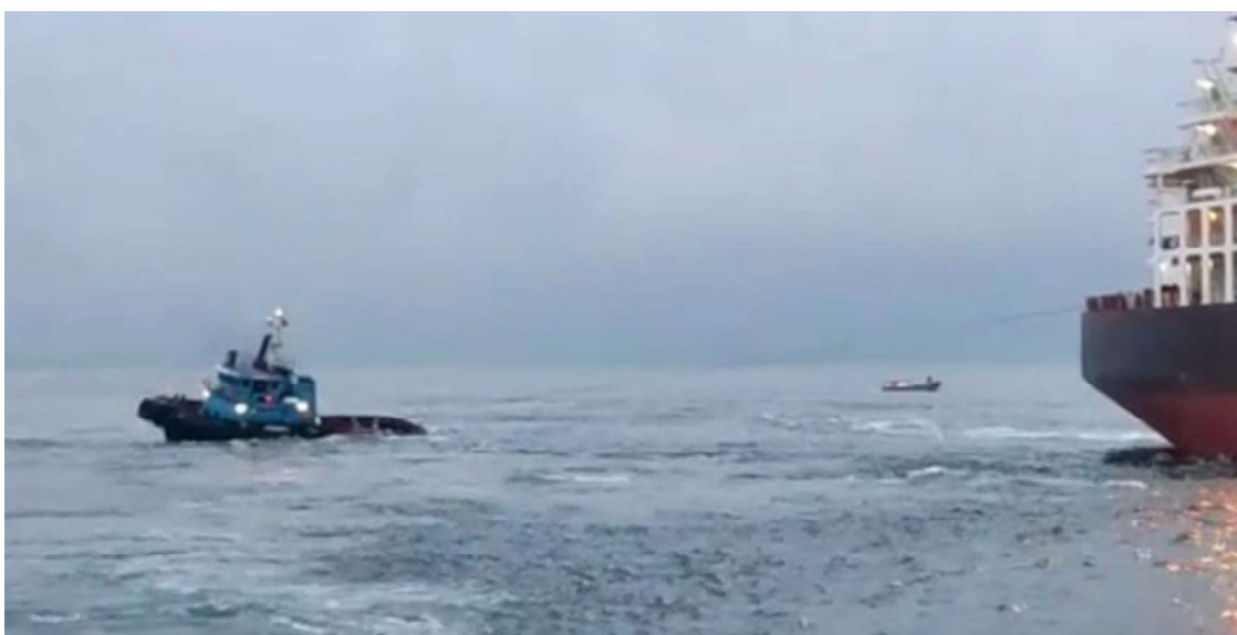
Figura No7.- Imagen cuando se logra ver incremento de tensión en tira del remolcador PIEDAD I y escora de éste.
