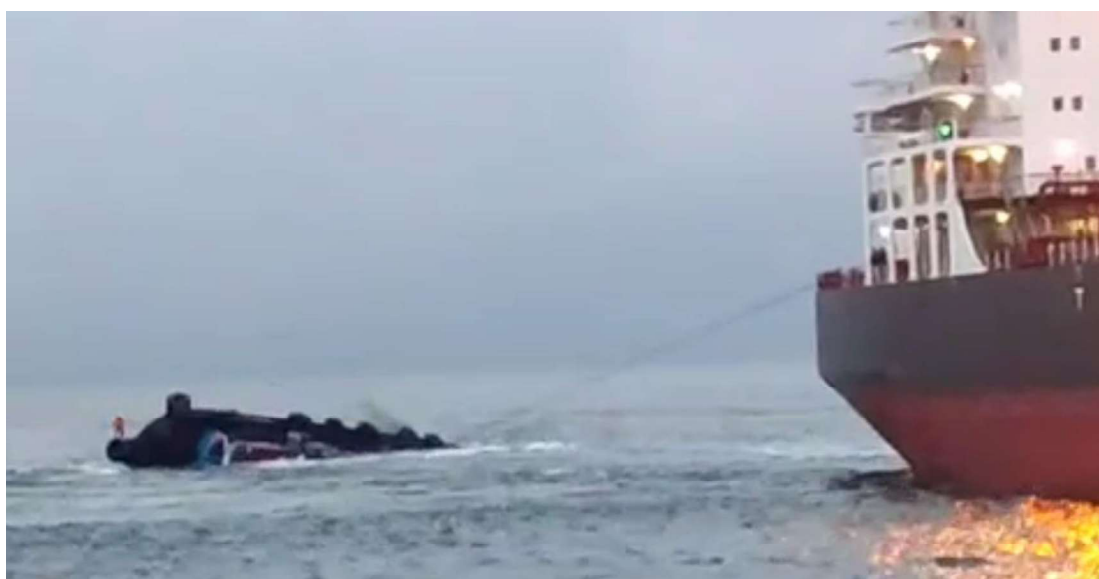
Figura No10.- Imagen donde se logra ver al remolcador PIEDAD I con un ángulo de escora aproximado entre 40° y 60°
